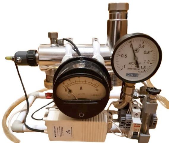
*Рис. 1 – Экспериментальный стенд по определению мощности бактерицидного УФ-излучения коронного разряда в водной среде*
